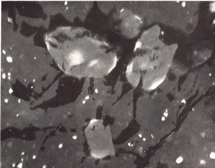
Abb. 52. Extensiv verbreitet sind in den Kreittionitporphyroblasten (im Foto sehr dunkelgrau) Einschlüsse von Zirkon (etwas heller, mit vielen Innenreflexen). Um diese herum sind in der Regel, auch im Foto, radialstrahlige Sprengungshöfe (im Foto schwarz) zu beobachten. Sehr hellgrau: Magnetit. — Vergr. ca.  $750\times$ , 1/7 Fl Öl.
