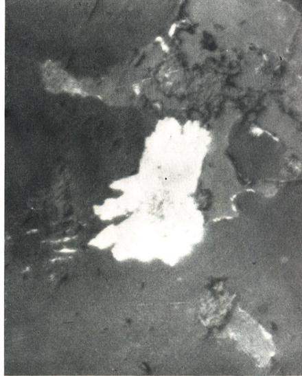
Abb. 26. Anatas im Auflicht in der Hornsteingangbreccie. Reflexionsvermögen zinkblendearartig, aber durch himmelblaue Innenreflexe mit ziemlicher Sicherheit  $TiO_2$ . Gangart Quarz. Vergr. ca. 600 ×,  $\frac{1}{7}$  Fl Öl.
