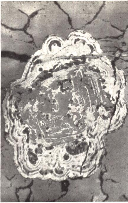
Abb. 19. Zonar durch  $\text{SiO}_2$  verdrängter alter Uraninitkristall. Das verdrängte  $\text{UO}_2$  bildet einen kolloidalstruierten Randsaum um den Uraninit. Die Hauptmasse der Gangart (mittelgrau) ist Quarz. Vergr. ca.  $150\times$ , P 3 b.
